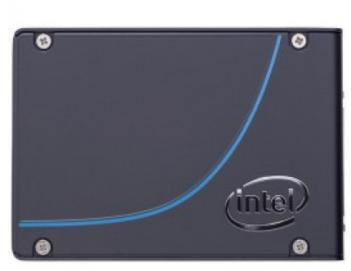
Interfejs U.2 2.5" (SFF-8639) MLC Technologia Pojemność 800 GB Przepustowość 32 Gb/s Maks. prędkość odczytu 2800 MB/s Maks. prędkość zapisu 1900 MB/s IOPS 4kb random reads 460000 IOPS 4kb random writes 90000 2.5" Format MTBF 2000000 h Endurance 14.6 PBW DWPD 10 Wysokość 15.00 mm Waga 115 g Gwarancja 5 lat
